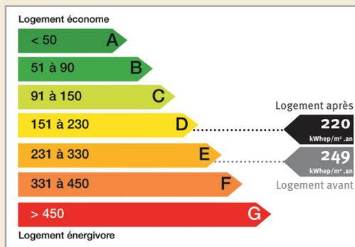
\* Maison avec murs en parpaings creux, non isolés. Sur terre plein et sur sous sol. Sous combles perdus, isolant laine de verre 15 cm. Simple vitrage bois avec et sans volets. Résultats obtenus sur la base de situations effectuées par une société de diagnostic énergétique indépendante au 01/02/2011
