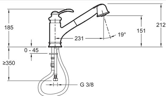
Description : Mitigeur évier avec douchette extractible. E76091. Collection : FAIRFAX. Poids : 2,6 kg. Type d'installation : 1 trou. Débit : 7 l/mn. Raccords : Avec flexibles d'alimentation. Mécanisme : Cartouche à disques céramique. Bec orientable douchette extractible, 2 jets anti-calcaire.
