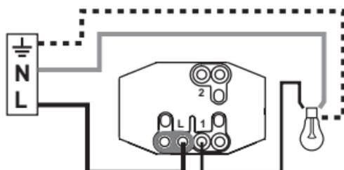
En interrupteur, commande d'1 seul endroit
