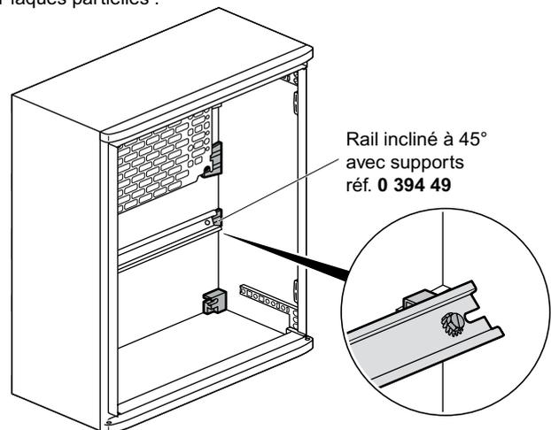
Exemple d'un coffret réf. 0 362 52 avec plaque partielle et rail montés sur plots intermédiaires.
