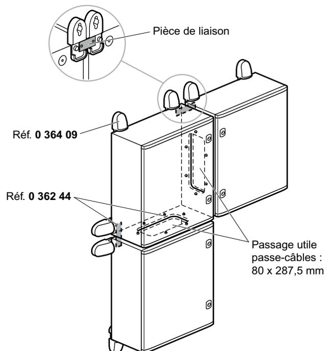
A partir de la hauteur 800 mm, il est possible de monter 2 cadres passe-câbles sur la hauteur du coffret.
