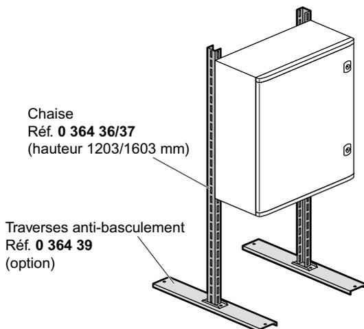
La chaise réf. 0 364 37 est livrée avec les accessoires pour conserver l'IP 66 et la classe II au niveau de la fixation traversante.
