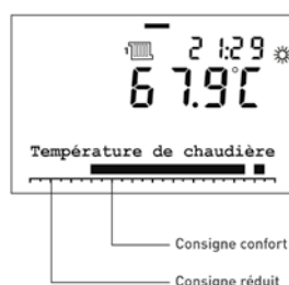
Affichage sur l'écran d'accueil de la programmation horaire et des données de fonctionnement
