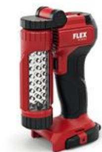
Lampe de travail LED puissante avec 24 LED blancs et protection de déchargement intégrée. Tête LED pivotante 320 ° et 180° tournante. Avec un crochet tournant pour accrocher la lampe et clip ceinture. Temps de travail: environ 20 h avec accu 2,5 Ah et 40 h avec accu 5Ah. FLEX système d'accu: convenable pour tout les pack accus 18 V. Accu n'est pas compris.
