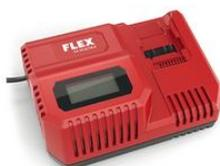
Pour charger des accus de 10,8 et 18,0 V. Avec écran LCD grand pour diagnostique des accus et état de chargement. Temps pour charger: environ 40 min pour des accus 18,0V/2,5 Ah et environ 50 min pour des accus 18,0 V/5,0 Ah. Par une procédure de chargement spéciale 80 % de la capacité est atteinte après 30 min. Avec refroidissement intégrée, protection d'échauffement, déchargement et surchargement.
