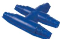
Ce kit garantit une isolation et une étanchéité complète lors de raccords en Té de conduites UNO, DUO ou QUADRO. Le kit comprend deux coquilles en PE-HD, isolation en laine de roche, mastic bitumineux, boulons en inox et notice d'installation. Les manchons thermorétractables sont à commander séparément.
