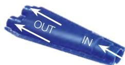
Ce kit garantit une isolation et une étanchéité complète lors de raccordements d'une conduite QUADRO à deux conduites DUO ou d'une conduite DUO à deux conduites UNO. Le kit contient deux coquilles en PE-HD, isolation en laine de roche, mastic bitumineux, boulons en inox et notice d'installation. Les manchons thermorétractables sont à commander séparément.
